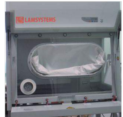
DEKONTAMINATION MIT FORMALDEHYD UND H 2 O 2 (BEGASUNG) Die Sicherheitswerkbank ist für alle Begasungsverfahren geeignet. In der Betriebs- und Wartungsanweisung ist ein vereinfachtes Desinfektionsverfahren mit Formaldehyddämpfen beschrieben.
